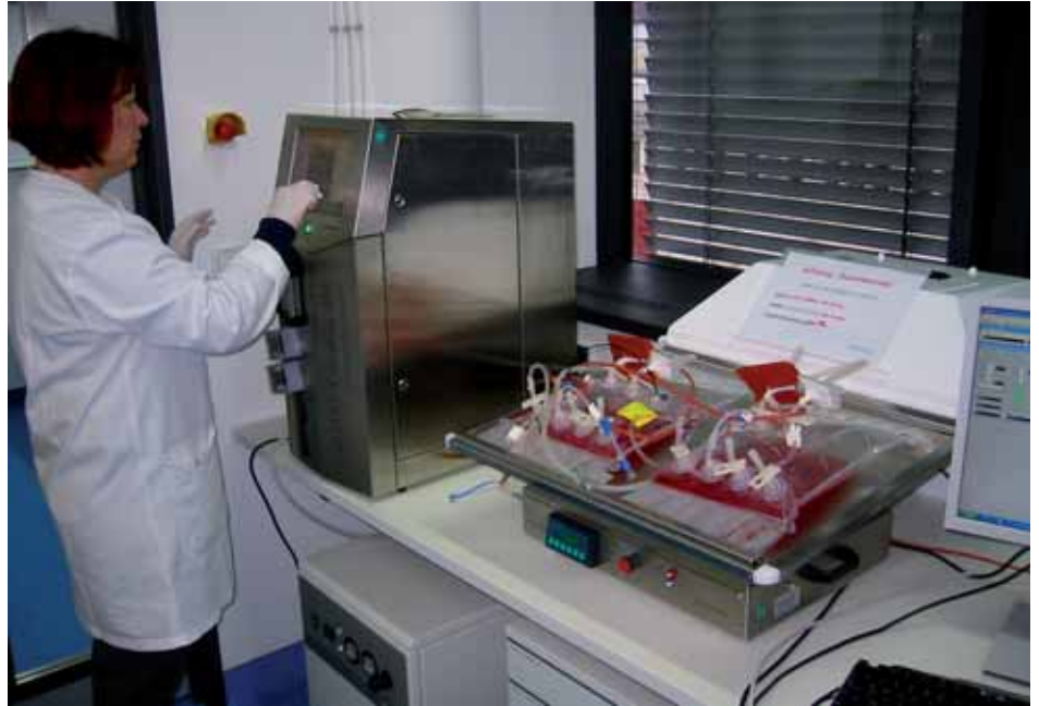
GLP-gerechte Produktion monoklonaler Antikörper im Labormaßstab im 20L-WAVE-Bioreaktor.
